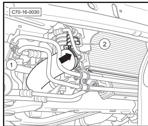
3. 松开卡箍-箭头-，断开中冷器进气管 - 1 - 与增压器 - 2 - 的连接，取下中冷器进气管 - 1 - 。
