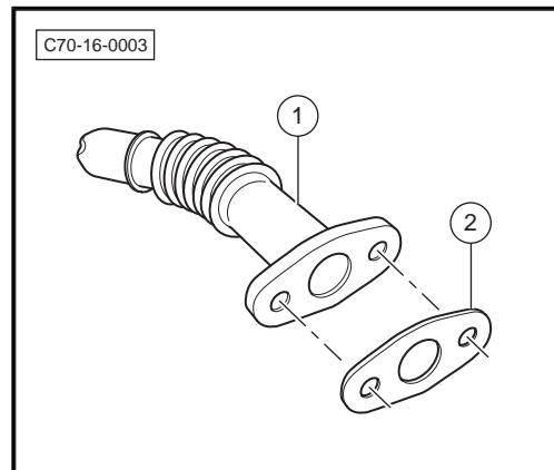
5. 拆卸增压器进气导管。=> [页 293](#)
