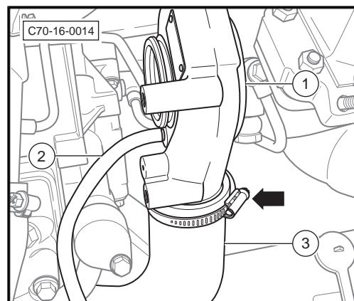
8. 旋出催化器总成 - 1 - 与增压器 - 2 - 的连接螺母-箭头-并将其连接分离。
