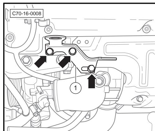
11. 旋出排气歧管隔热罩 - 1 - 的固定螺母-箭头A-, 取下排气歧管隔热罩 - 1 - 。
