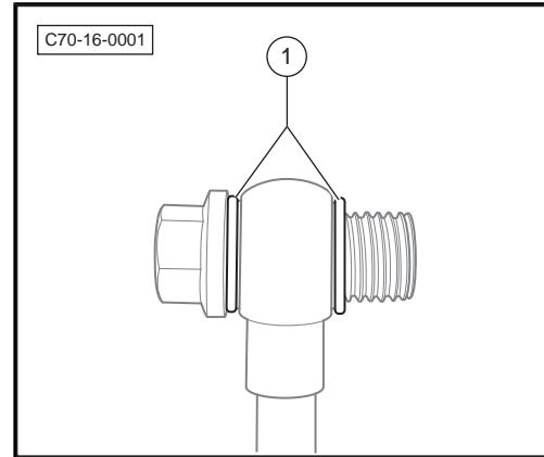
10. 旋出增压器进水管 - 1 - 两端的三通螺栓-箭头A-、-箭头B-，取下增压器进水管 - 1 - 。
