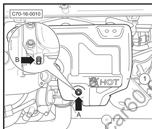
12. 旋松增压器进气导管 - 1 - 的卡箍螺栓-箭头-, 使增压器进气导管 - 1 - 能够摆动。
