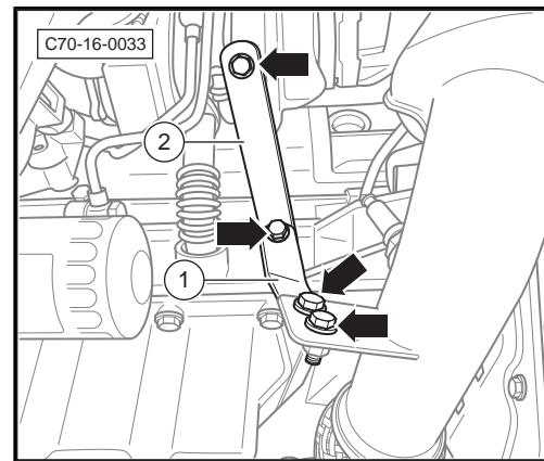
4. 旋出增压器出油管-1-的固定螺栓-箭头-，取下增压器出油管-1-。
