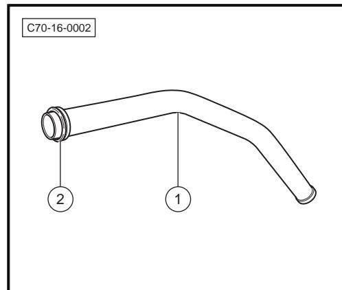
9. 拔出与增压器进气导管 - 1 - 连接的软管 - 2 - 。
