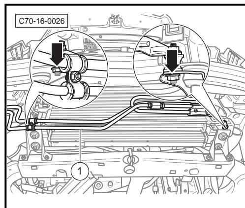
9. 旋出散热器支架 - 1 - 的固定螺母-箭头-, 取下散热器支架 - 1 - 。
