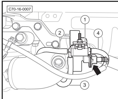
7. 旋出旁通管 - 1 - 的固定螺栓垫片组件-箭头A-，移出旁通管 - 1 - 。
