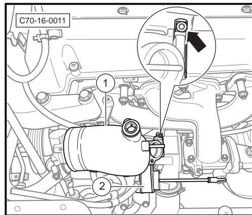
13. 拔出与增压器废气门控制阀 - 1 - 连接的软管 - 2 - 。
