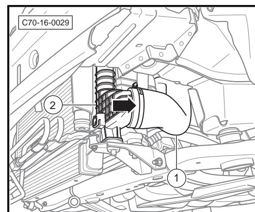
6. 旋出机油散热器 - 1 - 的固定螺栓-箭头-, 将机油散热器 - 1 - 移到一旁。
